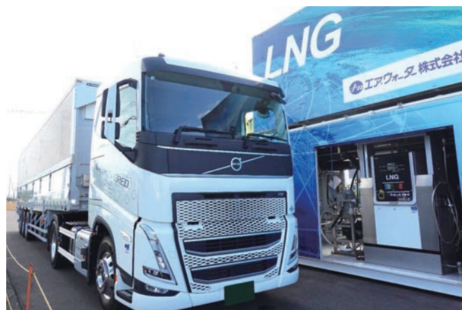
苫小牧市に設置されている小型LNG充填設備とボルボFH LNGトラック。
