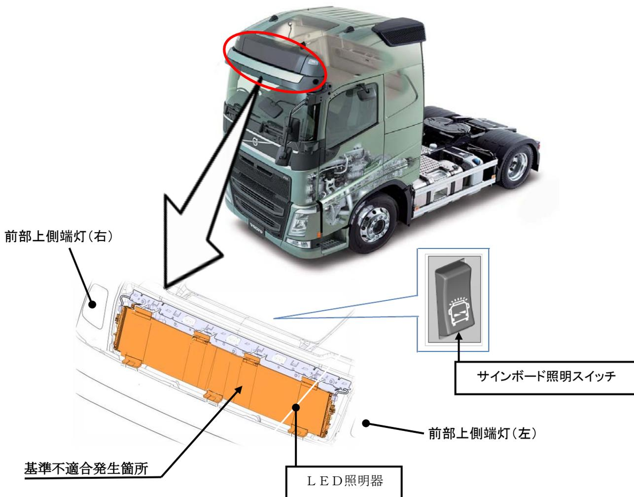
大型トラックのハイルフモデルにおいて、前部上側端灯間の中央部分（サインボード）の仕様に不備があり、保安基準第42条に定める基準に適合していません。
