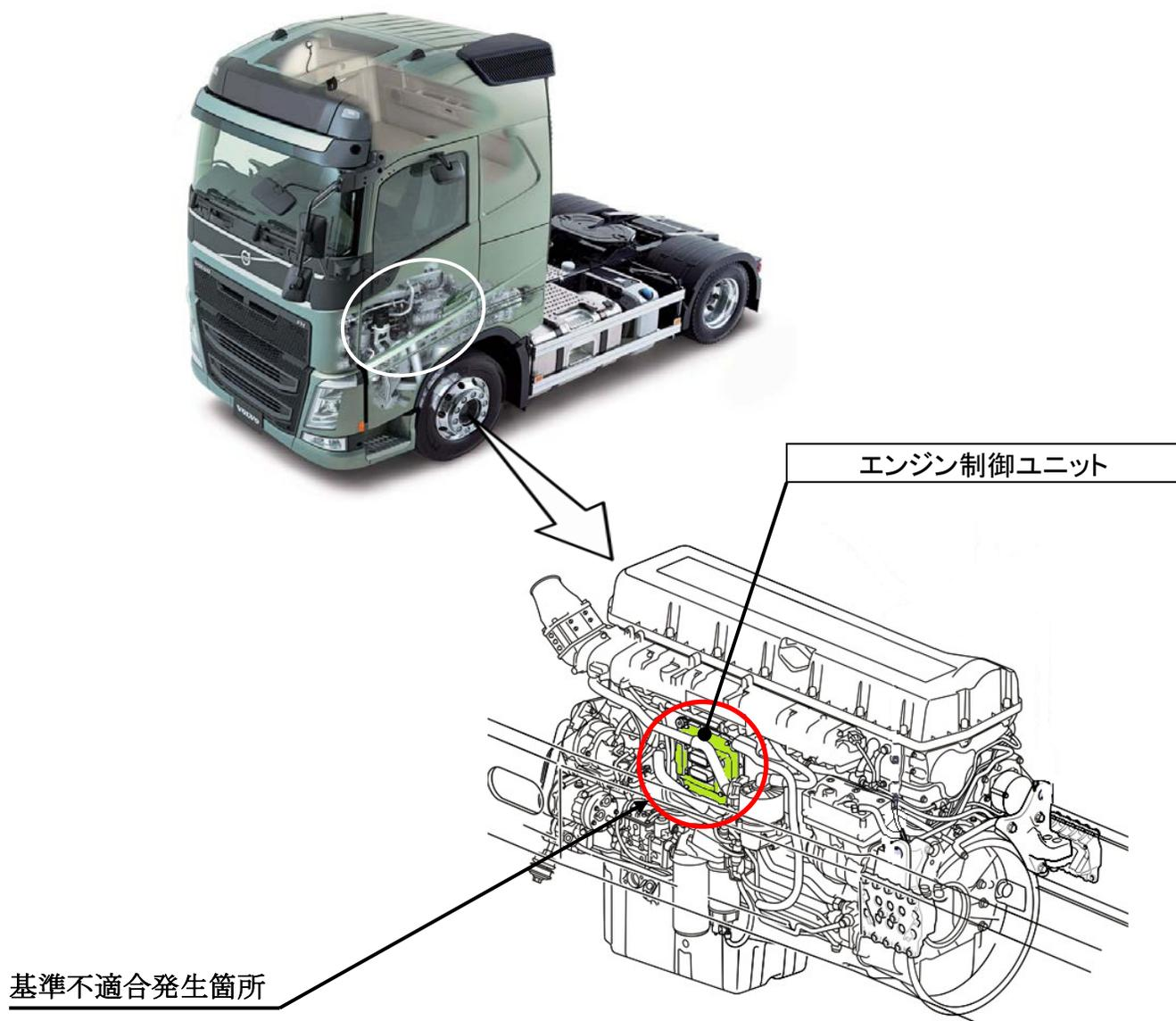
大型トラックのエンジン制御ユニットにおいて、エンジン制御プログラムが不適切なため、排気温度が低い状態では尿素が噴射されず窒素酸化物 (NOx) の排出値が保安基準第 31 条に適合しなくなるおそれがある。
