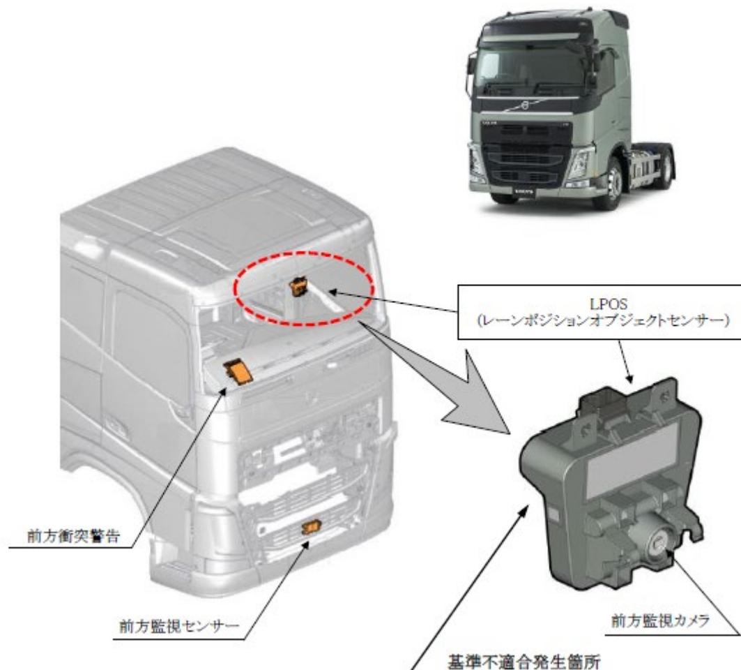
大型トラックの衝突被害軽減制動制御装置において、LPOS（レーンポジションオブジェクトセンサー）のプログラムが不適切なため、超低速による旋回後の直進時に前方監視センサー及びカメラによる検知機能が低下することがあり、予期せぬ制動に至ることがある。そのため、保安基準第12条（制動装置の基準）に適合しなくなるおそれがある。
