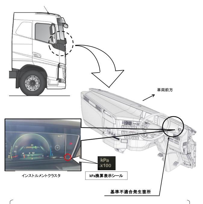
液晶ディスプレイに表示される空気圧力計の単位表示において、国内における作業指示が不適切なため、SI単位に換算する表示の貼付がされていない。そのため、道路運送車両の保安基準第47条の2にかかる内圧容器圧力表示の規定に適合しない。
