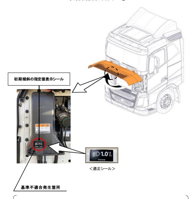
すれ違い用前照灯の初期傾斜指定値表示において、車両に貼付する表示の確認が不十分なため、 誤った表示になっている。そのため、道路運送車両の保安基準第32条にかかるすれ違い用前照灯 の初期傾斜指定値表示の規定に適合しない。
