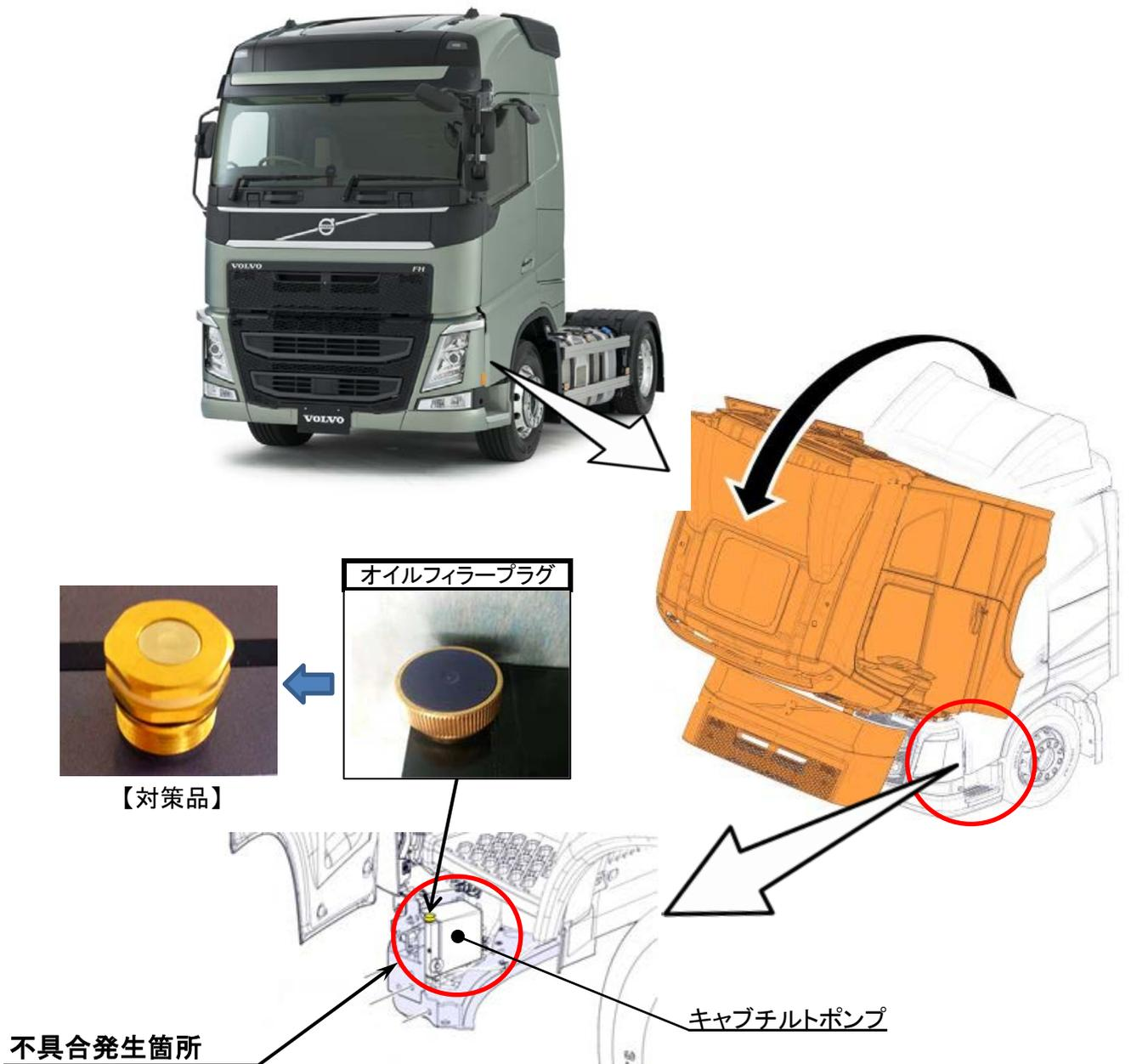
大型トラクタの車体装置において、キャブチルトポンプのオイルフィルタープラグの材質が不適切なため、キャブを上下する際の油圧変動によって当該プラグからオイル漏れを起こすことがある。そのため、そのままの状態で使用を続けると、キャブチルトシリンダ内のオイルが不足してキャブを保持できなくなり、急降下するおそれがある。
