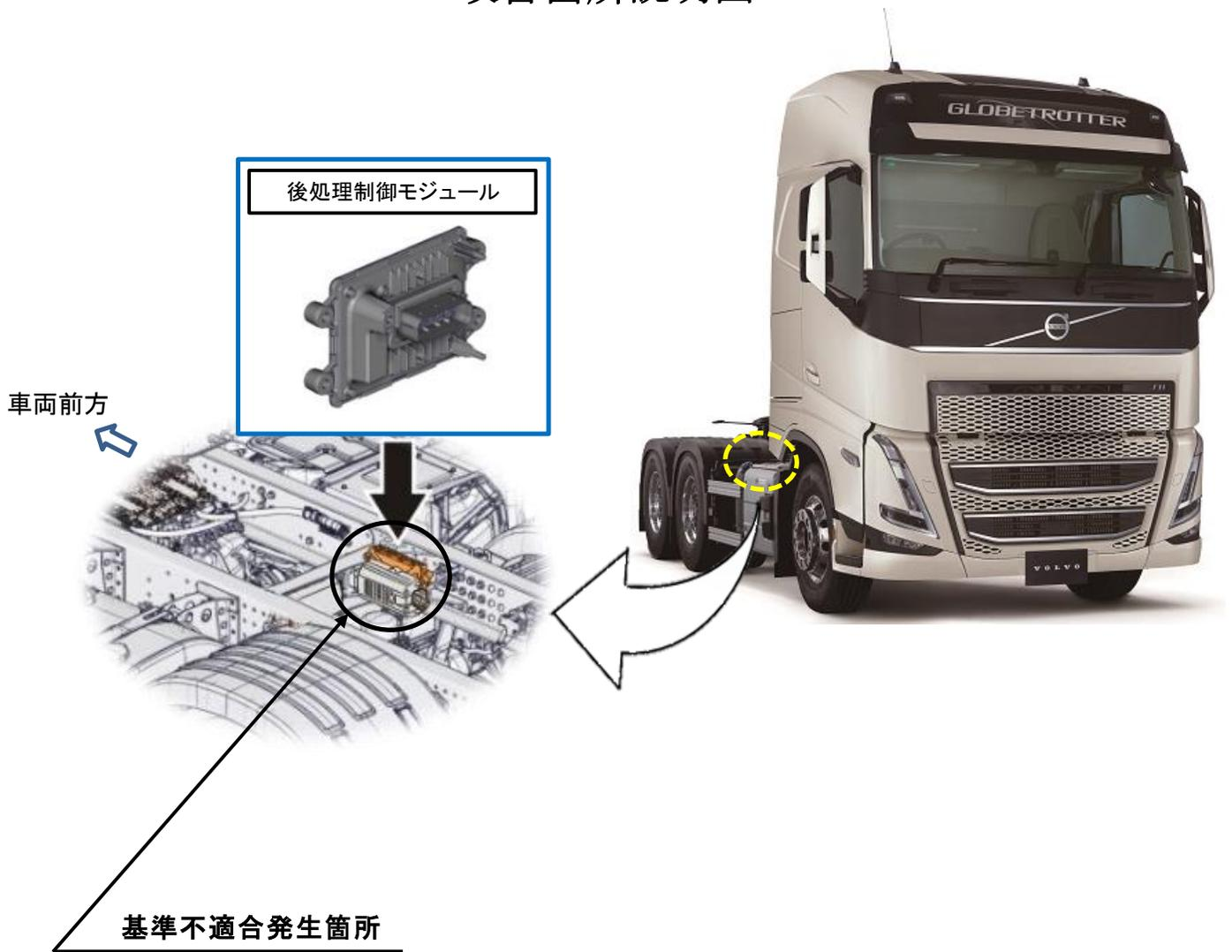
後処理制御モジュールにおいて、プログラムの書き込み時にデータ読み出し設定が不適切なため、汎用故障診断ツールで故障発生時の運転状況を示すデータを読み出すことができない。そのため、道路運送車両の保安基準第31条の細目告示第41条別添48の車載式故障診断装置（ディーゼル重量車J-OBD II）の技術基準に適合していない。
