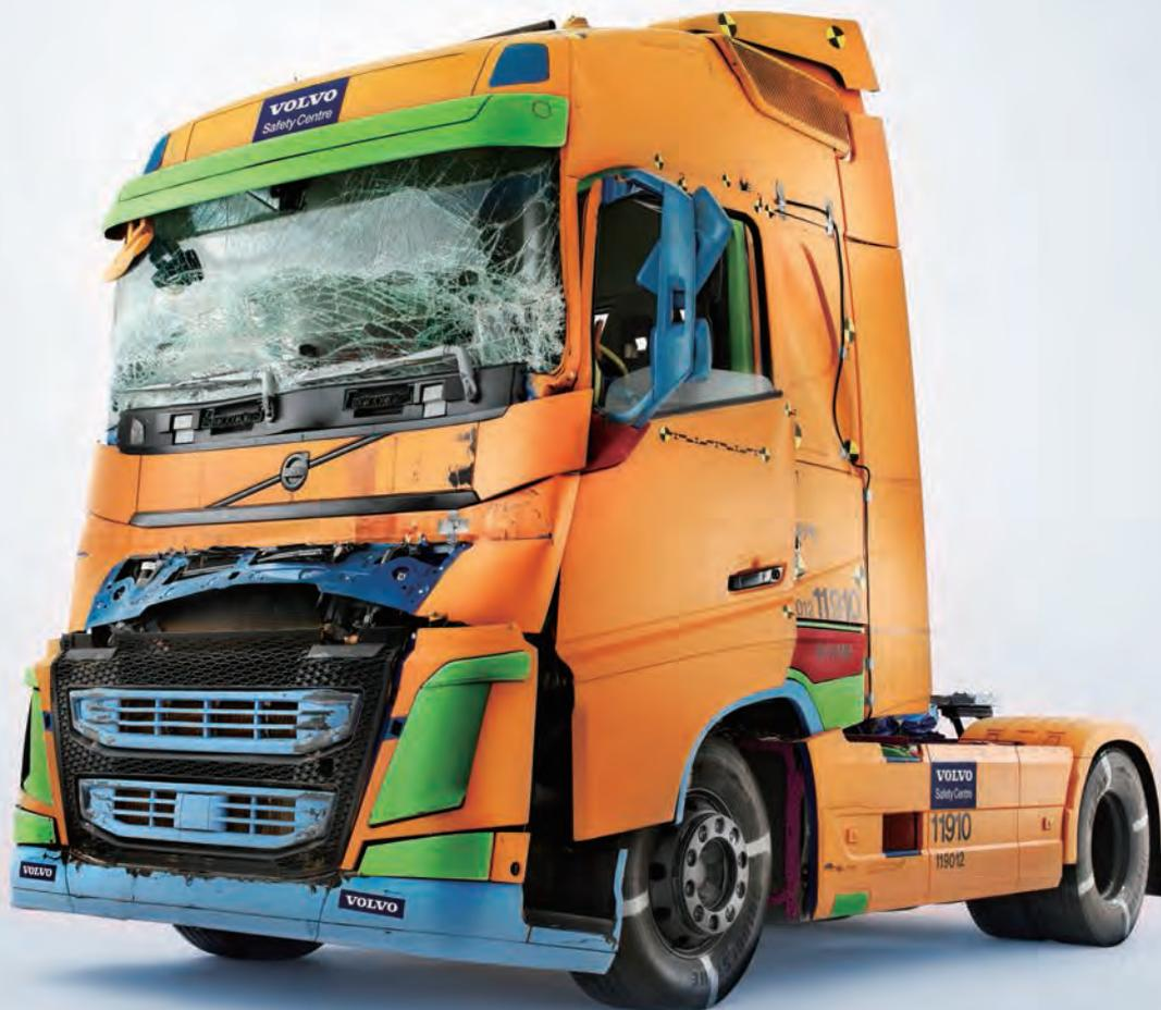
ボルボ FH のキャブ構造は、ゼロからデザインされたものです。その結果、ボルボ史上最も安全なキャブが誕生しました。たとえ、静止している物体に時速 80 キロで衝突したとしても、ドライバーの命を高い確率で守ります。それは、世界で最も厳しいといわれるスウェーデン式衝突試験で実証済み。この試験では、ルーフへの 17 トンの圧力や、リアと A ピラーへの 29.4 キロジュールの衝撃にも耐えてきました。しかし、いくらキャブ構造が頑丈でも、飛んできたパーツでケガをするようなら、安全なトラックとは言えません。だから、ボルボでは、接合部の安全性についても、何度も繰り返しテストを行っています。世界最高水準の安全性。それは、ボルボ・トラックが長年にわたって厳しい衝突試験を積み重ねてきた証なのです。
