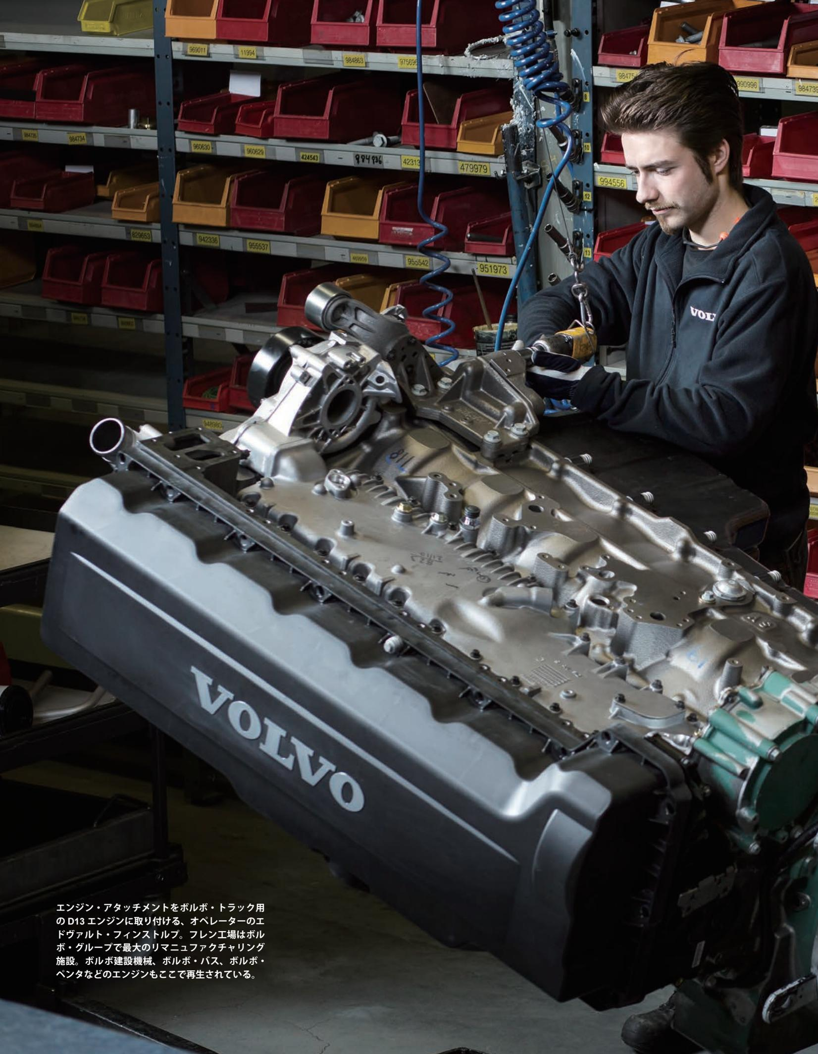
エンジン・アタッチメントをボルボ・トラック用のD13エンジンに取り付ける、オペレーターのエドヴァルト・フィンストルプ。フレム工場はボルボ・グループで最大のリマニュファクチャリング施設。ボルボ建設機械、ボルボ・バス、ボルボ・ベンタなどのエンジンもここで再生されている。
