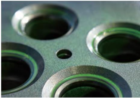
緑色に発光しているのは磁性粉末。このシリンダーヘッドはひび割れないことが確認できたため、再生エンジンに使用できる。
