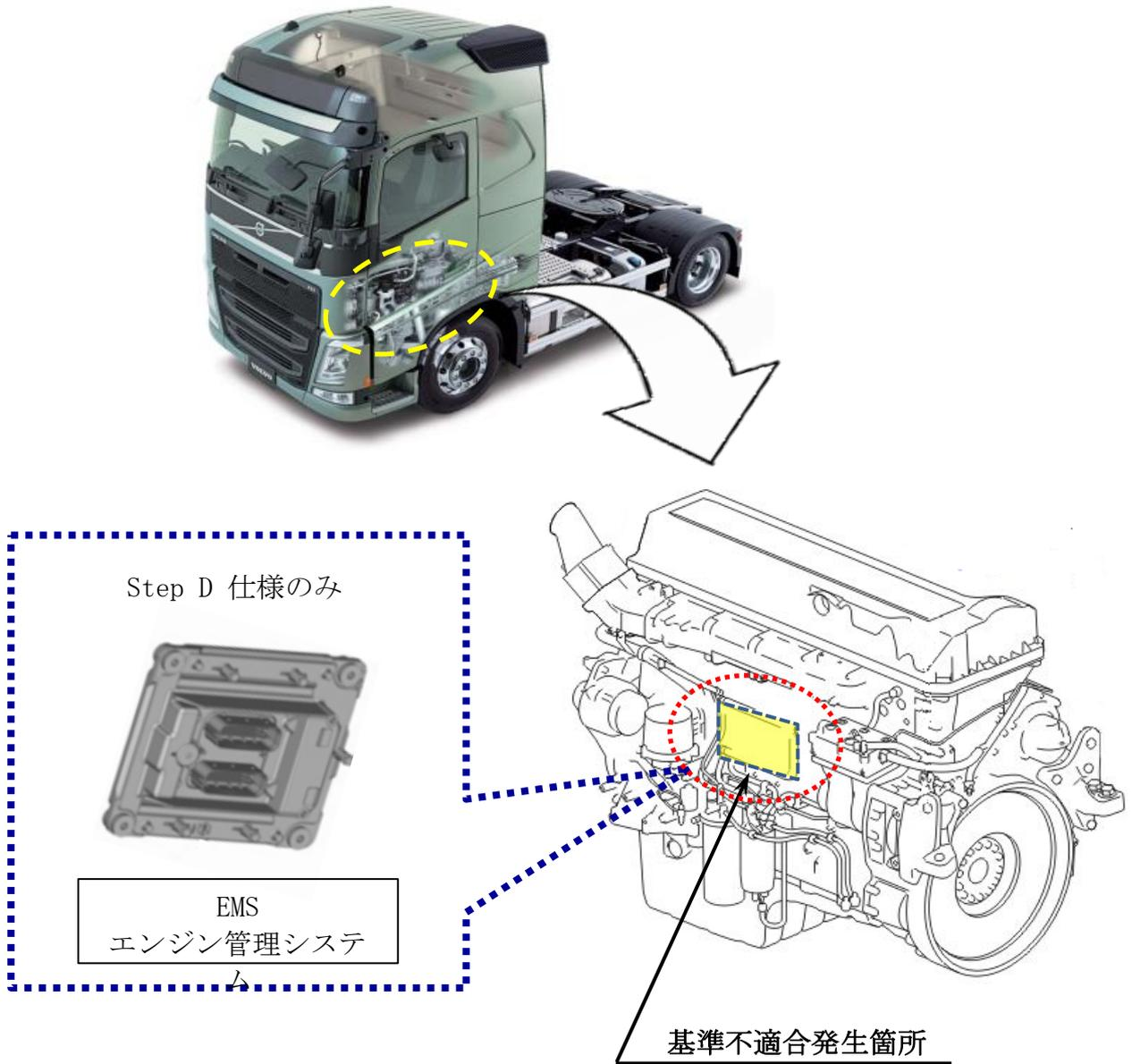
平成28年排出ガス規制対応の大型トラックの排出ガスシステムOBD（車載式故障診断装置）の故障診断コードにおいて、EMS（エンジン管理システム）のプログラム設定が不適切なため、OBDが、スキャンツール又は保守ツールから要求された際、故障コードを消去できないおそれがある。
